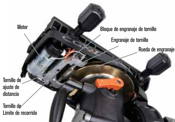
Figura 14 Encaje del engranaje de tornillo
