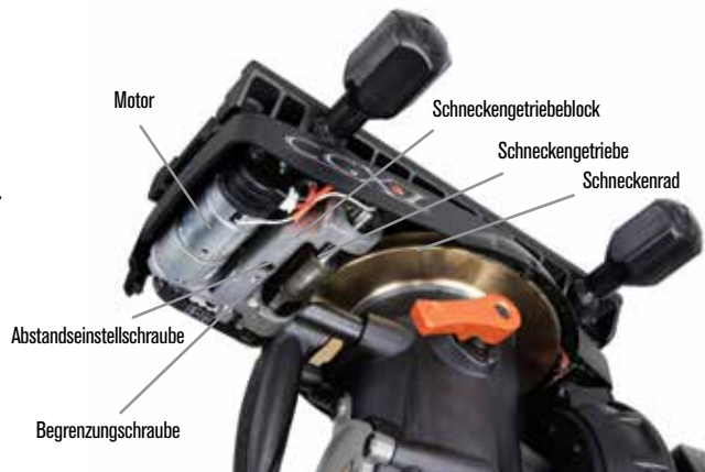
Abbildung 14 Schneckengetriebeverzahnung
