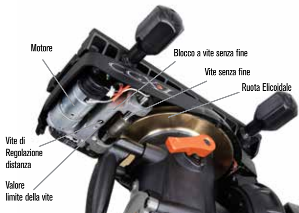
Figura 14 Ingranaggio a vite senza fine
